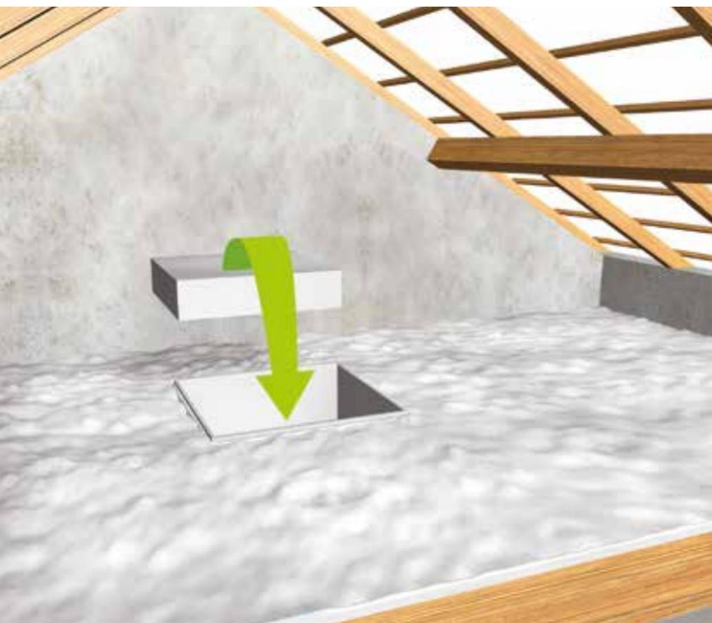
Le positionnement de la trappe doit permettre d'appuyer l'échelle sur un élément de charpente lorsque le cadre de la trappe n'offre pas une rigidité suffisante. De plus, la hauteur du cadre doit être supérieure d'au moins 5 cm à l'épaisseur de l'isolant soufflé. Les dimensions de la trappe doivent permettre le passage d'une personne. L'emplacement de la trappe doit permettre l'accès au comble.
